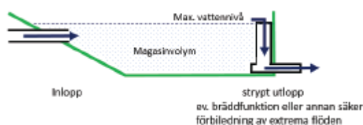
Figur 10: Möjlig utformning av en torr fördröjningsdamm (Svenskt vatten, Rapport 2019-20)
